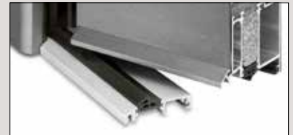
Wetterschenkel im Flügel vernietet, Wasser tropft vor der Schwelle ab
