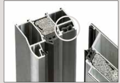
Montagenut für verdeckt liegende Rahmenverschraubung, deckt Schrauben ab, dadurch leichter zu Reinigen
