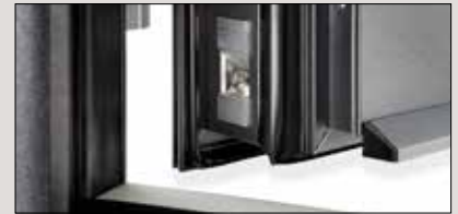
Eckverbindungen äußerst stabil, Profile auf Gehrung verschraubt, verklebt und verbolzt
