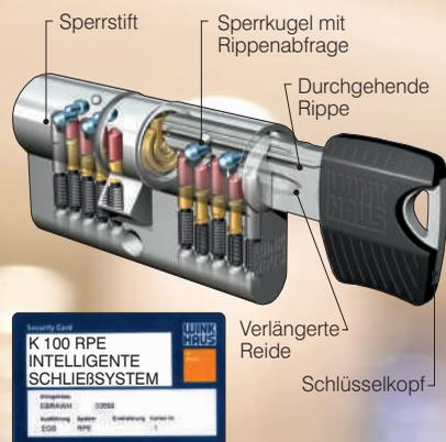
Vielseitig und sicher - heute und in Zukunft. keyTec RPE von Winkhaus ist das innovative System für die einzelgesicherte Schließung. Ein neuartiger Kopierschutz gibt Ihnen die Gewissheit, dass nur befugte Personen einen Nachschlüssel anfertigen können. Dies wird erreicht durch eine speziell ausgeprägte Rippe am Schlüssel, die im Schließzylinder durch eine Sperrkugel abgefragt wird.
